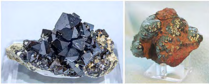
Figura 1: Esquerra: magnetita - \text{Fe}_3\text{O}_4 . Dreta: hematites - \text{Fe}_2\text{O}_3 . Si bé en el cas de la magnetita observarem la presència d'un únic material d'aspecte cristal·lí, podrem observar dues fases diferents en el cas de les hematites. D'una banda, en el \text{Fe}_2\text{O}_3 amorf hi reconeixem el color rogenc característic del ferro oxidat o rovellat. D'altra banda, un aspecte brillant i gris caracteritzarà el \text{Fe}_2\text{O}_3 a l'estat cristal·lí.
