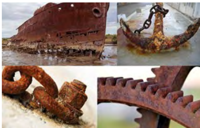
Figura 1: Efectes de la corrosió. En contacte amb medis químicament agressius apareix el fenomen de la corrosió en gran part dels aliatges metàl·lics, fet que induïx la degradació, completa o parcial, de les seves propietats mecàniques i, doncs, impossibilita la seva utilització.
